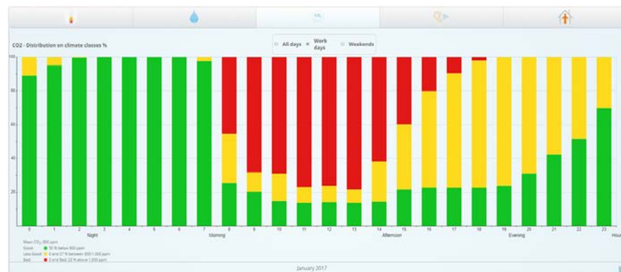
CO 2 -indhold fordelt på timer for et gennemsnitsdøgn. Bemærk at indeklimaet er rigtig godt frem til kl. 8.00 hvor undervisningen starter. Røde værdier betyder at CO 2 -indhold er over 1.000 ppm, hvilket ikke er acceptabelt.
